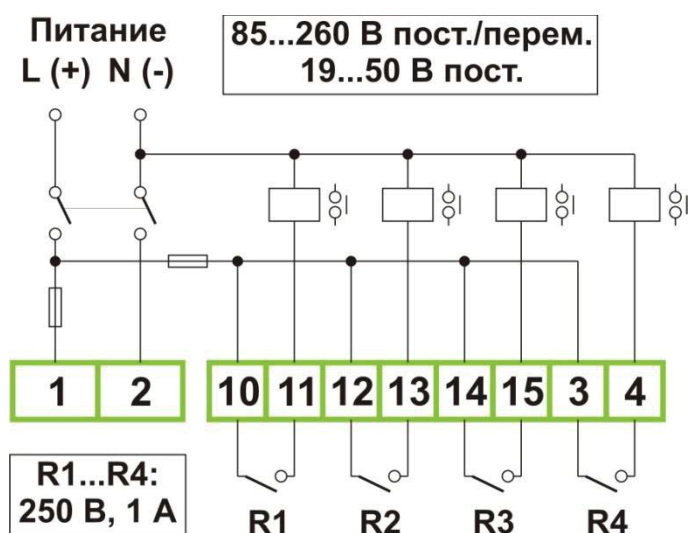
Рисунок 2.12. Пример включения реле выхода (тип – “сухой контакт”).
