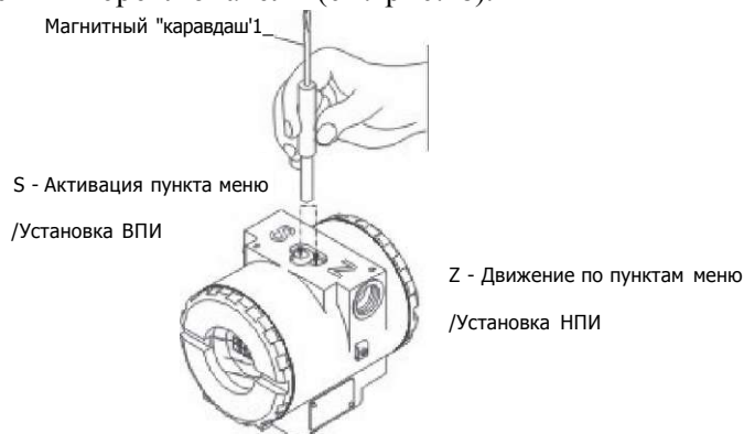
Рис. 8. Расположение элементов локальной настройки
